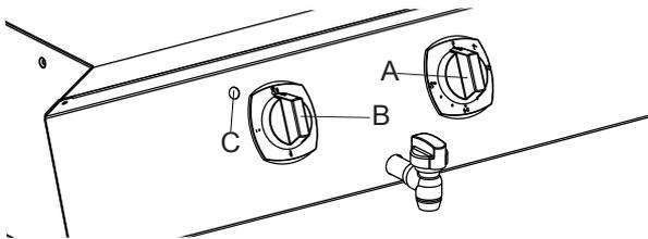
El testigo verde "C" se enciende para indicar que la máquina está encendida.
